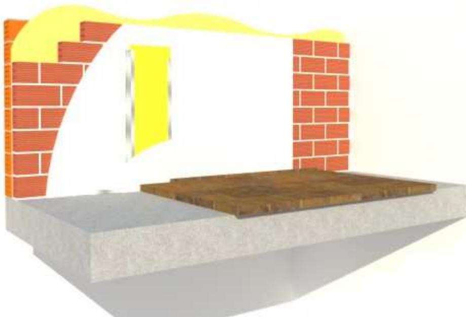
3.17. Sección constructiva colocación aislamiento por el interior acabado en placa de yeso laminado
