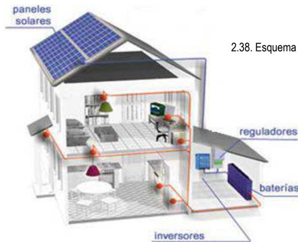
2.38. Esquema de instalación sistema fotovoltaico
