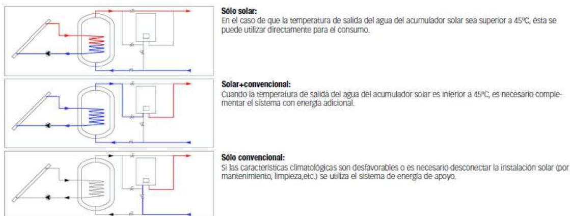
2.10. Modos de funcionamiento de una instalación solar térmica
