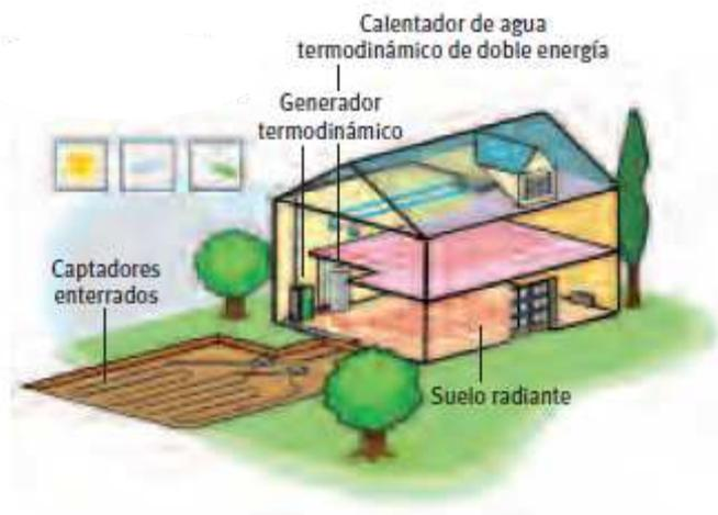
2.19. Esquema del principio de suministro de energía geotérmica
